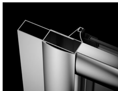
Premium Plus DWJ – профиль + 4 см. Стандартный U-образный профиль под магнит заменяется расширительным профилем P01-127190001.
