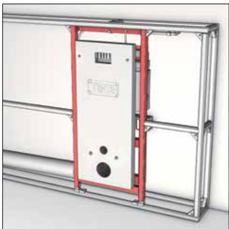
(2) Установка шаблона для отделки отверстия в стене.
